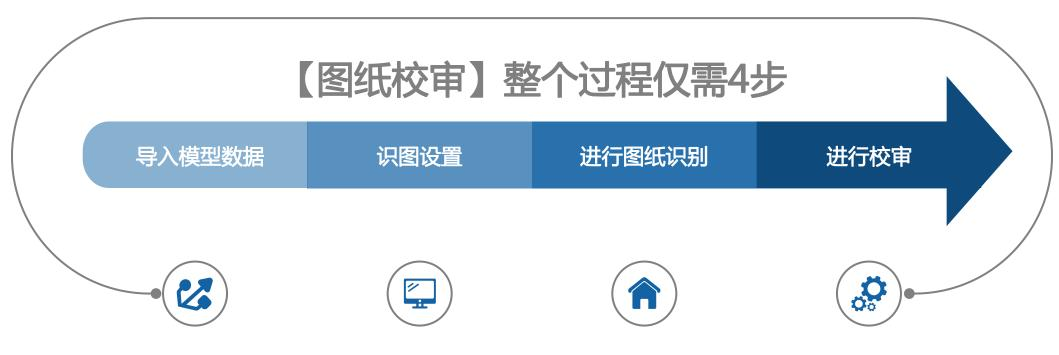
将模型数据完成与平面图 纸的对位,在对位时支持 对模型数据的任意旋转、 平移、删除等操作 将识别时的基本构件对应的图层进行分组,一个工程仅需设置一次,程序亦可自动完成图层分析
