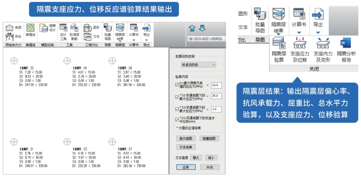
隔震层结果：输出隔震层偏心率、抗风承载力、屈重比、总水平力验算，以及支座应力、位移验算
