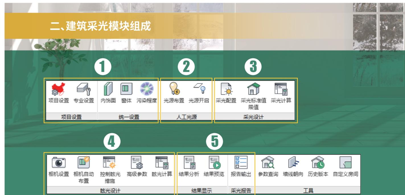
绿色建筑软件V2023R1.0建筑采光模块包括采光设置、人工光源、采光计算、眩光计算及报告书输出五部分内容，具体功能组成如下：
