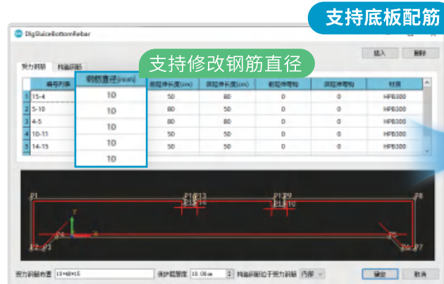
设置底板配筋对话框
