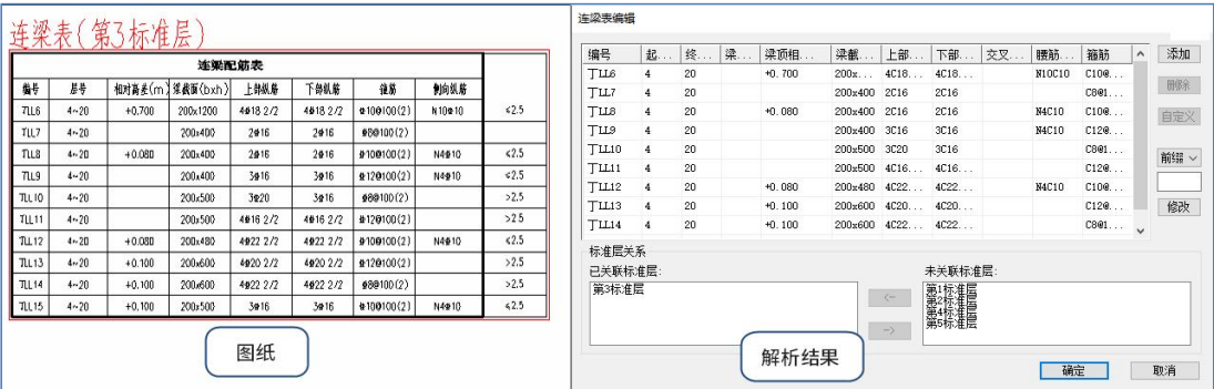
图 2.1.4-14 连梁表自动解析结果
