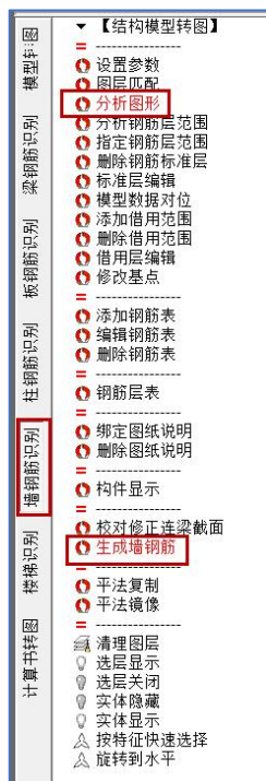
图 4.3.3-1 “墙钢筋识别”步骤
